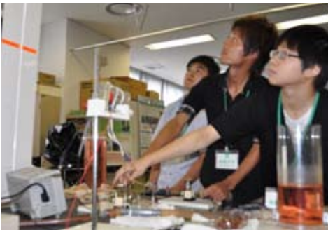
人工臓装置。空気圧で動作する拍動型ポンプ（心臓）が、チューブとタンク（全身の血管）につながっている。ポンプが送り出す液体（血液）は、チューブとタンクを経て、再びポンプに戻る（循環）。ポンプの動作状態などを変え、循環する液体の圧力（血圧）への影響を理解する。嶋津研究室で作ったオリジナルの装置。
