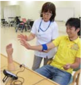
上肢切断者の前腕に残存している筋の筋電位を利用して義手の把持動作を制御する筋電義手を用い、筋電位制御のしくみを体験する学生。左は指導にあたる森田教授。
